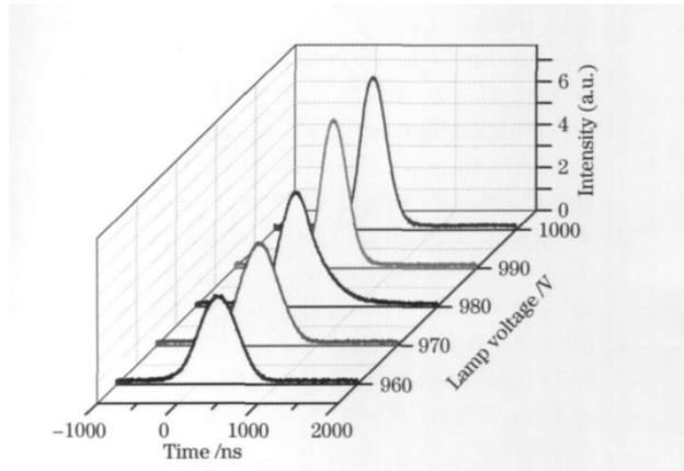
图 6 电光调 Q 下重复频率为  $2\ \text{Hz}$  时的脉冲波形
