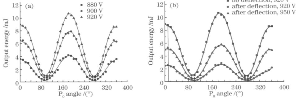
图 3 (a) 静态下不同抽运电压时输出激光的偏振态和 (b) 将  $\text{LiNbO}_3$  晶体在水平面偏转小角度与以布儒斯特角放置时偏振态的对比图
