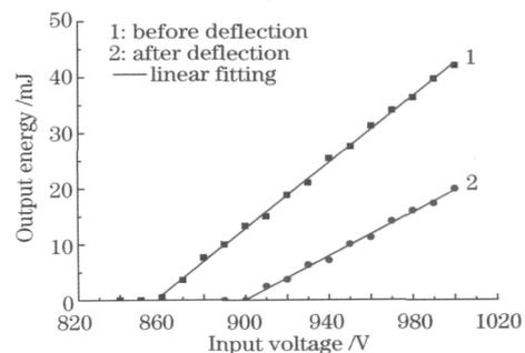
图 2 静态下 LiNbO<sub>3</sub> 晶体偏转前后激光器的输出能量曲线
