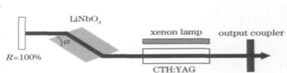
图 1 CTH:YAG 激光器实验装置
