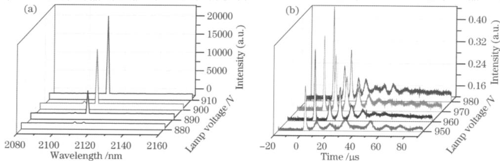
图 4 静态时不同抽运电压下 CTH:YAG 激光器的 (a) 输出激光光谱和 (b) 脉冲波形
